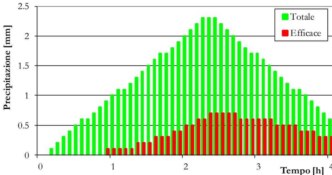
Figura 4.4: ietogramma di progetto utilizzato per la determinazione dell'idrogramma di piena (TR200).
