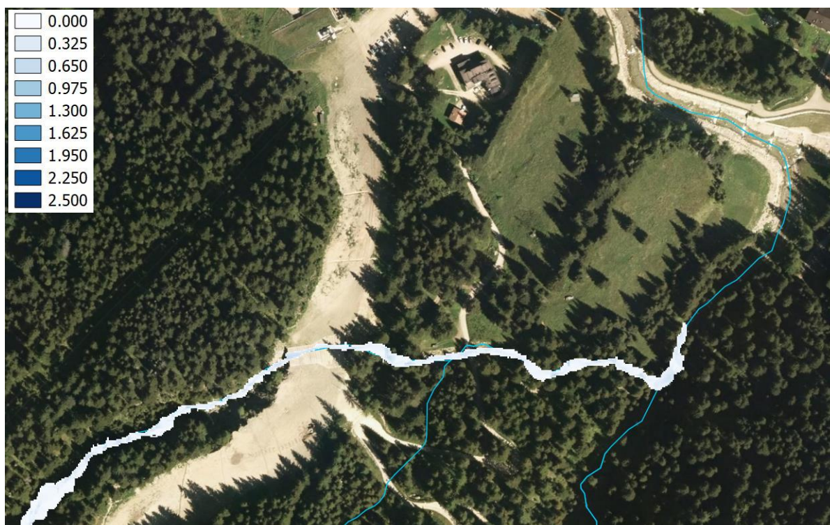
Figura 6.3: Spessore di propagazione della colata con TR 200 anni [m] su ortofoto, per un istante temporale pari a 0,5 h dall'inizio dell'evento.
