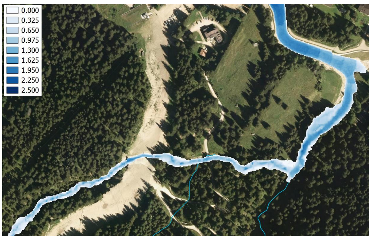
Figura 6.7: Spessore di propagazione della colata con TR 200 anni [m] su ortofoto, per un istante temporale pari a 2 h dall'inizio dell'evento.
