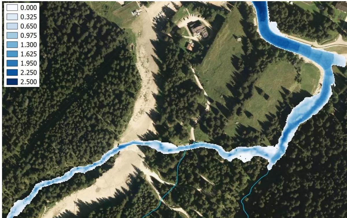
Figura 6.9: Spessore di propagazione della colata con TR 200 anni [m] su ortofoto, per un istante temporale pari a 3 h dall'inizio dell'evento.
