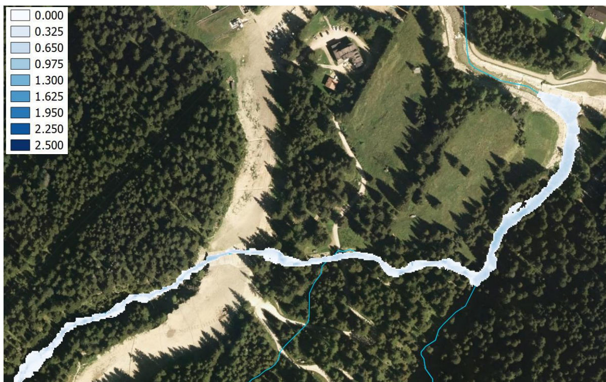
Figura 6.5: Spessore di propagazione della colata con TR 200 anni [m] su ortofoto, per un istante temporale pari a 1 h dall'inizio dell'evento.
